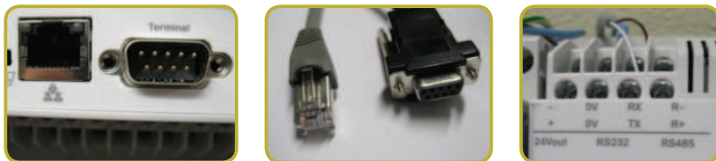
De gauche à droite : port RJ-45 pour Ethernet, port 9 broches pour RS 232 ou RS 485 ; fiche RJ-45 pour Ethernet et 9 broches pour RS 232 ou RS 485 ; bornier de raccordement pour RS 232 et RS 485
