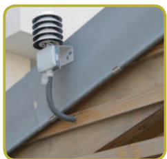
La sonde est sur la façade nord, protégée du Soleil par un abri ventilé anti-rayonnement
